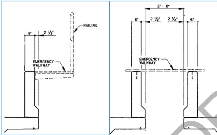
FIGURE 24: EMERGENCY WALKWAY FOR SINGLE (LEFT) & TANGENT (RIGHT) GUIDEWAYS
